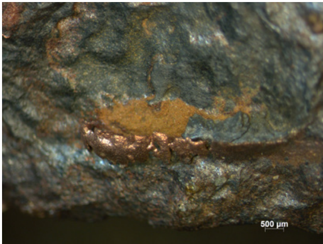
Fig. 325. Udtagning af prøve 1 fra side A under mikroskop. Den kobberfarvede tråd før prøveudtagning, 20x forstørrelse, forsiden af prøven (venstre) og efter udtagning 40x forstørrelse, bagsiden af prøven ses, fanget på klistrende kulfilm (højre). Den hvide målestoksbjælke måler 0,5 mm (500 µm). Foto: Jannie Amsgaard Ebsen.
