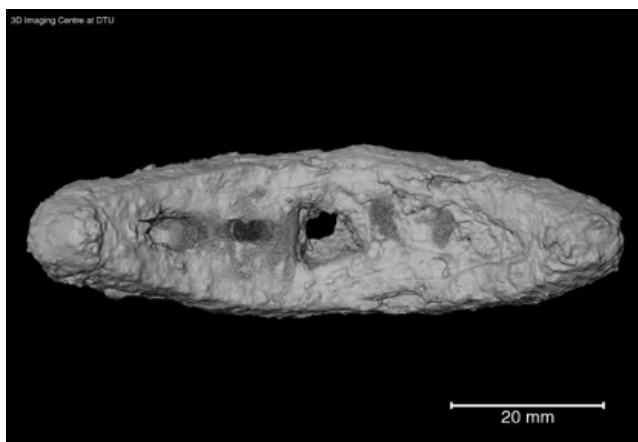
Figur 348. \mu -CT-scanninger af overhjaltet set nedefra med det dækkende jernkorrosionslag (venstre) og den bevarede jernkerne "fritlagt" for korrosion ved hjælp af særlig CT-software (højre). Her kan også taucheringen ses, liggende frit "svævende" ca. 1-2 mm over jernets overflade. Foto: Carsten Gundlach og Sina Baier-Stegmaier, DANFIX, DTU.
