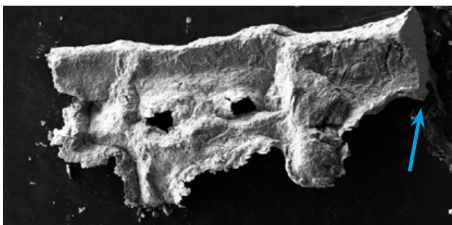
Fig. 328. Bagsiden af en del af prøve 3 af den kobberfarvede metaltråd efter omtrentlig halvering på tværs (skærringssted angivet med den blå pil) ved 184x forstørrelse i SEM. Foto: Arne Jouttijärvi, Heimdal-archaeometry.
