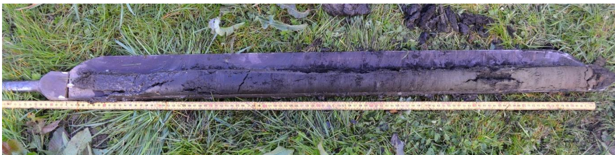
Borekerne A fra ca. 90-190 cm under terræn. Foto: Mogens Bo Henriksen.
