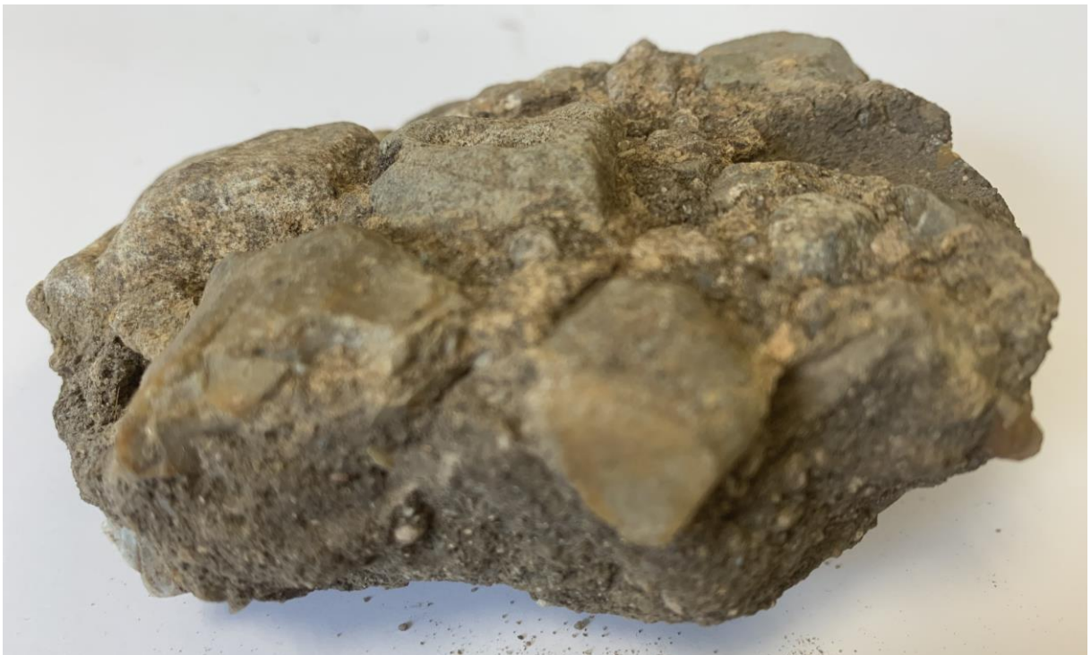
Figur 3. Udtaget stykke af vejen, ca 6 x 4 x 2 cm. Foto: Forfatteren.
